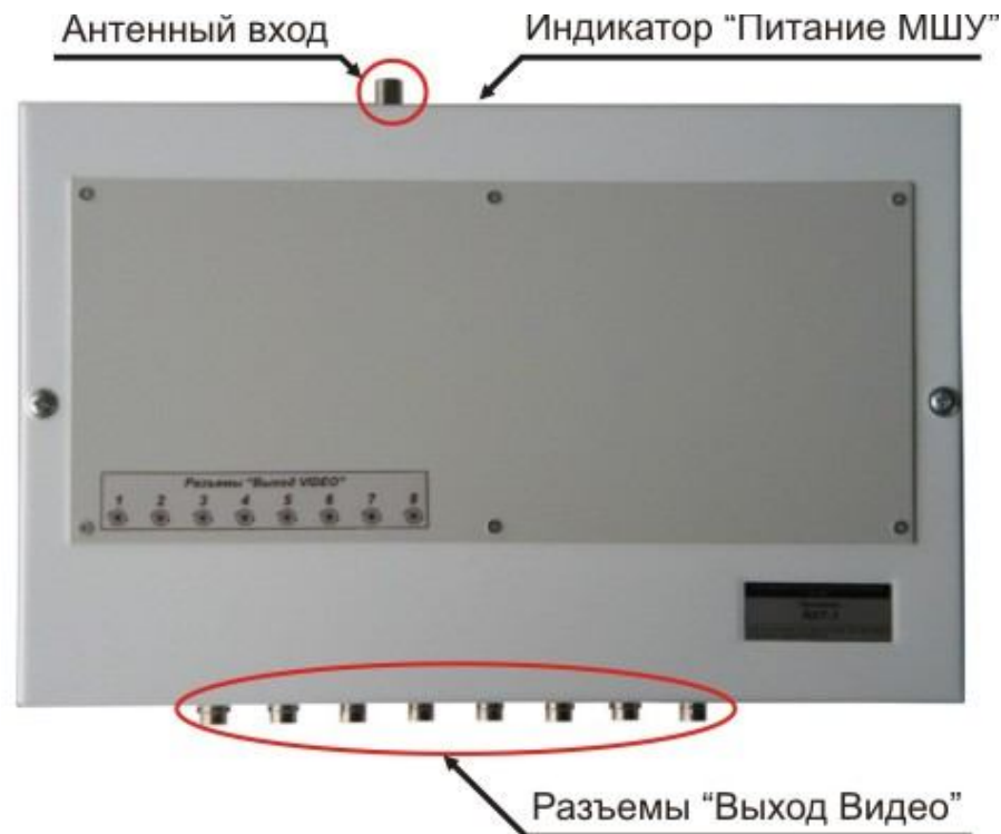
Рис. 2 Общий вид и назначение разъемов приемника RX8-1
