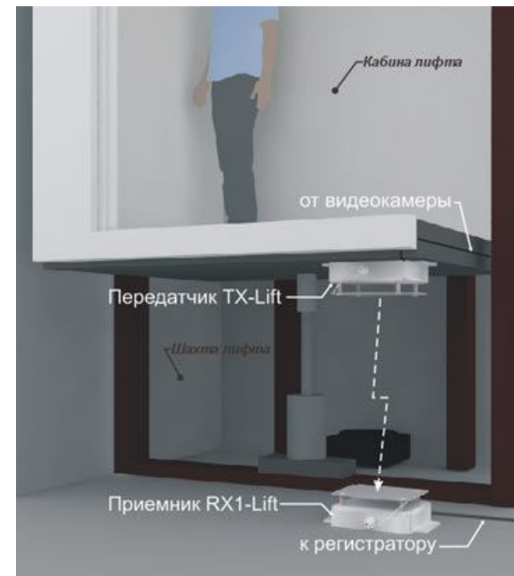
Рис.1.2 Установка приемника в нижней части лифтовой шахты
