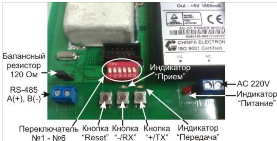
Рис. 3 Органы управления, индикации и разъемы
